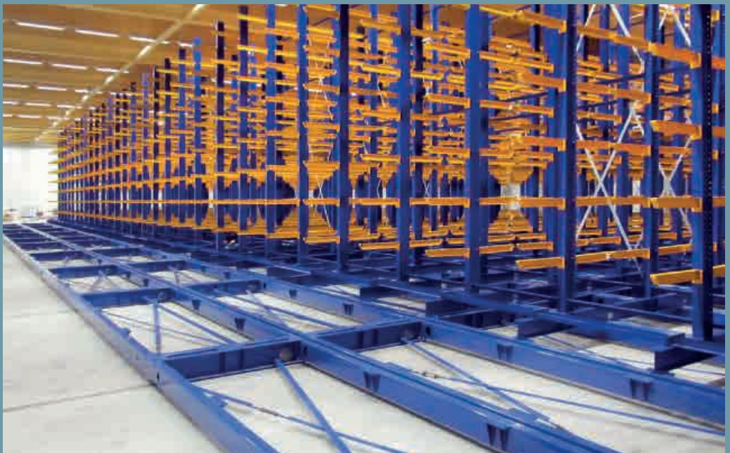
Besonders für die Lagerhaltung von unter-schiedlichen Aluminiumprofilen sind Verfahr-anlagen das optimale Lagersystem
