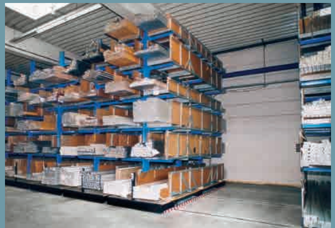
Besonders für die Lagerhaltung von unter-schiedlichen Aluminiumprofilen sind Verfahr-anlagen das optimale Lagersystem
