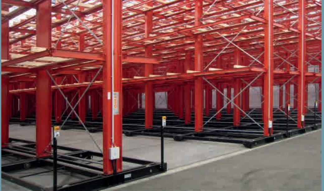
Verfahrenanlage unbeladen. Elektrisch betrieben per Knopfdruck für jeden einzelnen Verfahrwagen
