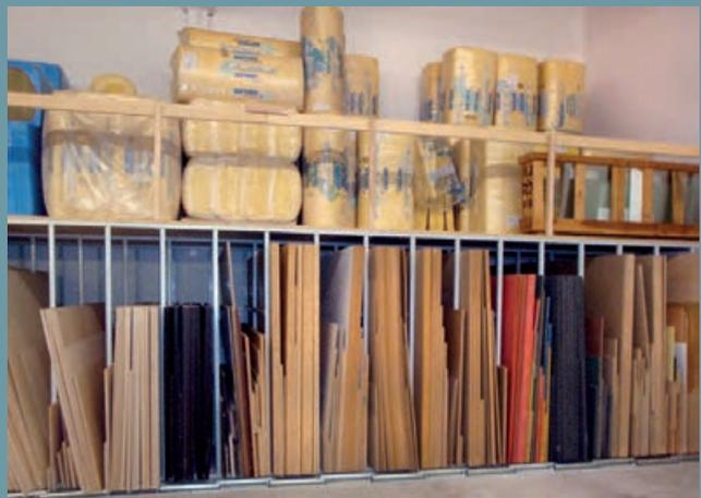
Stehende Lagerung von Spanplatten mit Nutzung der Oberseite als zusätzliche Lagerebene
