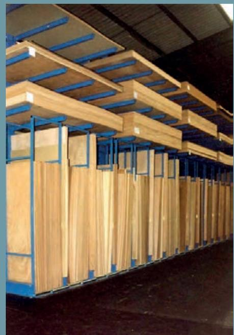
Kombination aus Kragarmregale mit integriertem Spanplattenregal. Hohe Lagerdichte auf geringer Grundfläche
