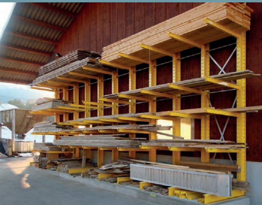
Langgutlagerung unter dem Vordach eines Zimmereibetriebes. Verschiedene Sorten und Abmessungen übersichtlich und sicher in einem Kragarmregal gelagert
