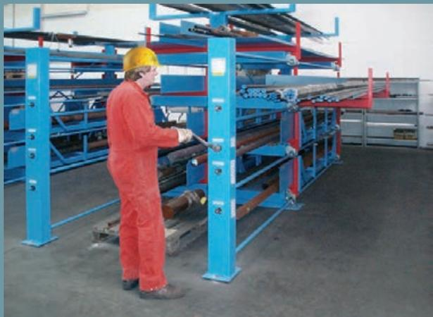
Eine ganze Lagerebene wird ausgefahren - das Lagergut ist von oben mit Kran störungsfrei zugänglich.
